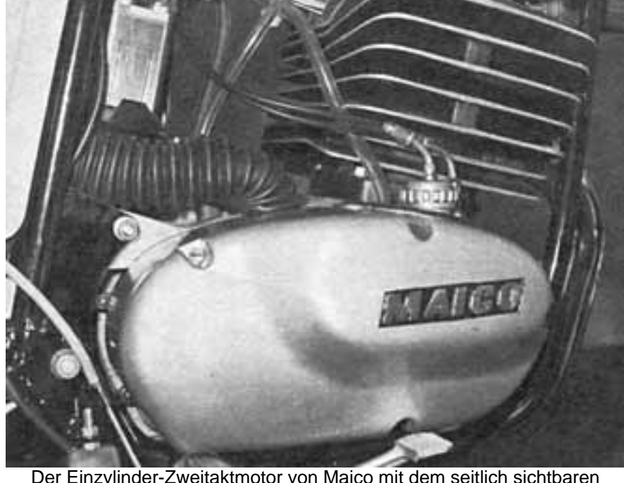
Der Einzylinder-Zweitaktmotor von Maico mit dem seitlich sichtbaren Drehschiebereinlaß soll nun auch als 250 ccm-Aggregat in Serie gehen. Es ist mit 54 mm Hub und 76 mm Bohrung ein Ultra-Kurzhuber.
