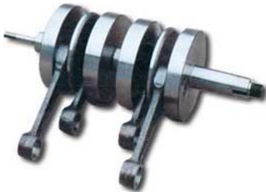
Die Wälzlager-Kurbelwelle von Hoeckle: 54mm Hub, zwei gegenläufige Pleuelpaare auf DK-Nadellagern.
