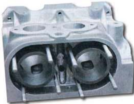
In die Blöcke sind Gußlaufbuchsen für 45,54 und 63mm Bohrung eingegossen. Umkehrspülung mit 3. Hilfskanal
